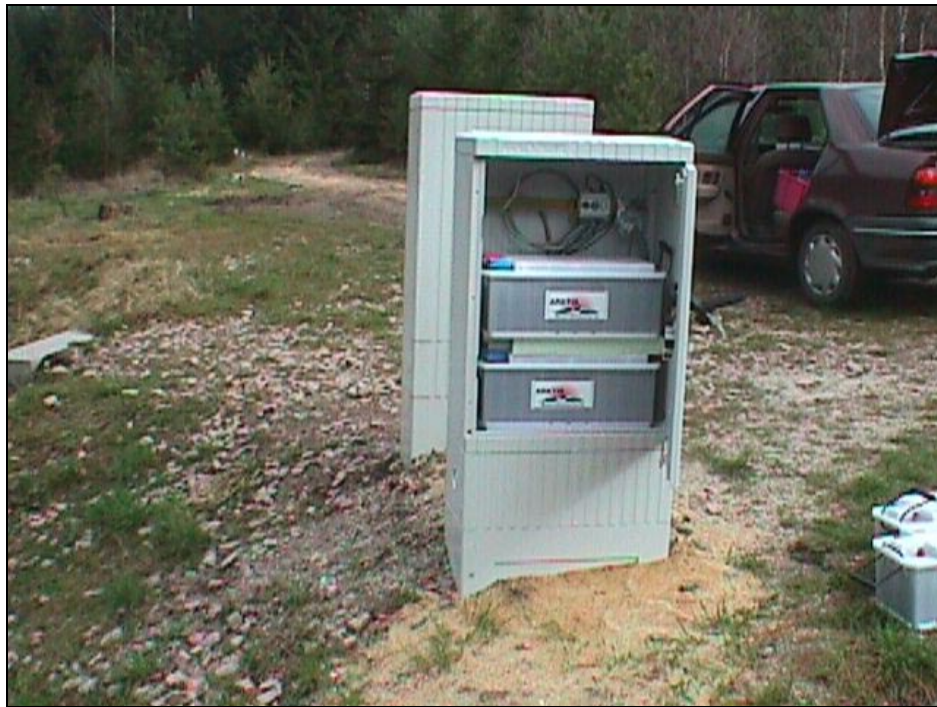
Bild 23 Schaltschrank zur Verwahrung der 12 V Batterien
