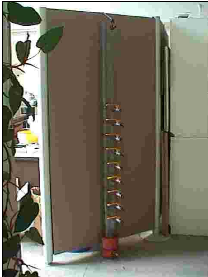
Bild 16 ungefüllte halbtechnische Kolonne vor dem Einbau
