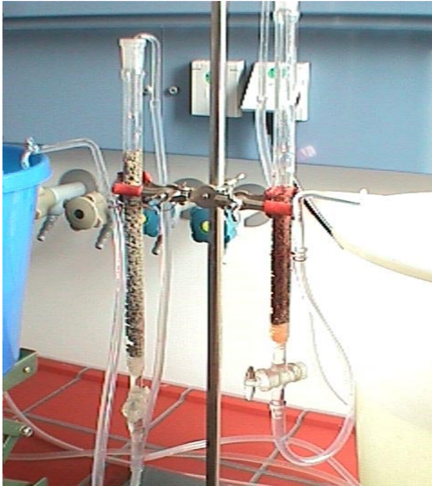
Bild 1: Versuchsaufbau Kleinkolonnen mit Teststoffen Diakat (links) und Eisenhydroxidgranulat (rechts)
