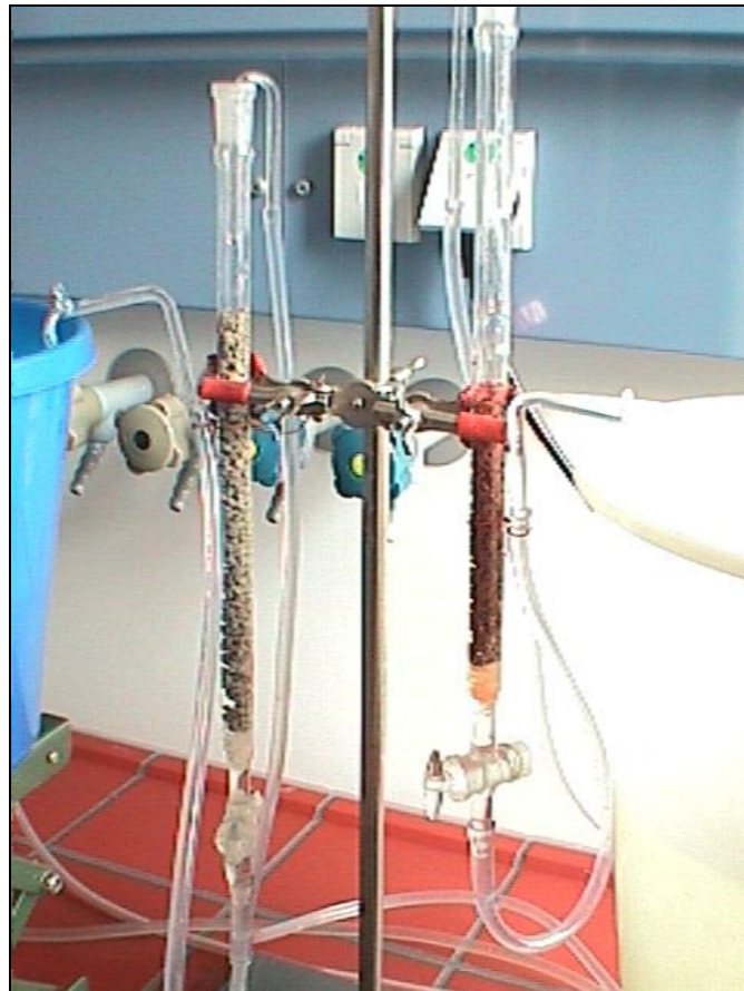
Bild 7 Kleinkolonnenversuche im Labor
